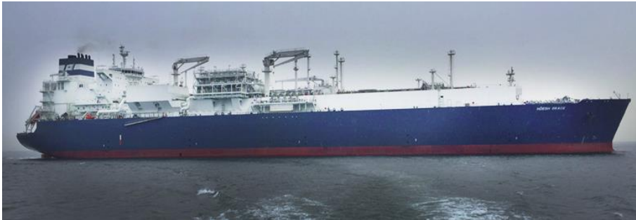
Embarcación en la cual se realizará el proceso de regasificación
